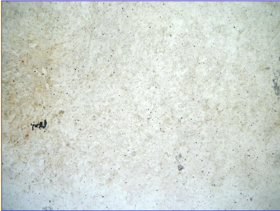
Gips drobnokrystaliczny (alabaster). Jeden polaryzator. Dłuższy bok zdjęcia-ok. 6,0 mm.
