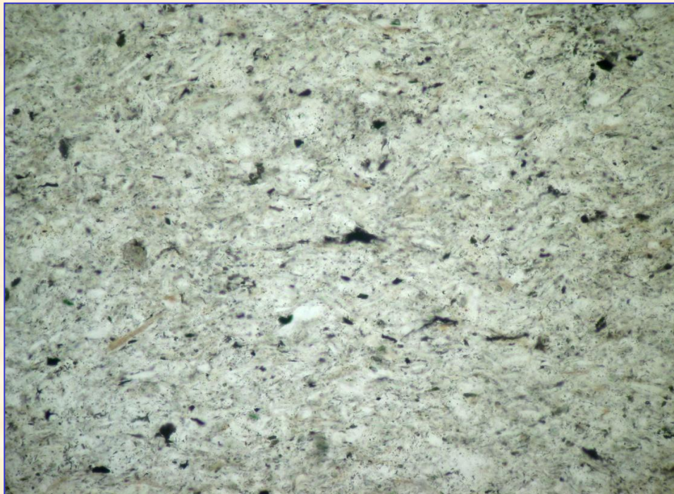
Minerały ilaste w iłowcu. Jeden polaryzator. Dłuższy bok zdjęcia-ok. 0,75 mm.
