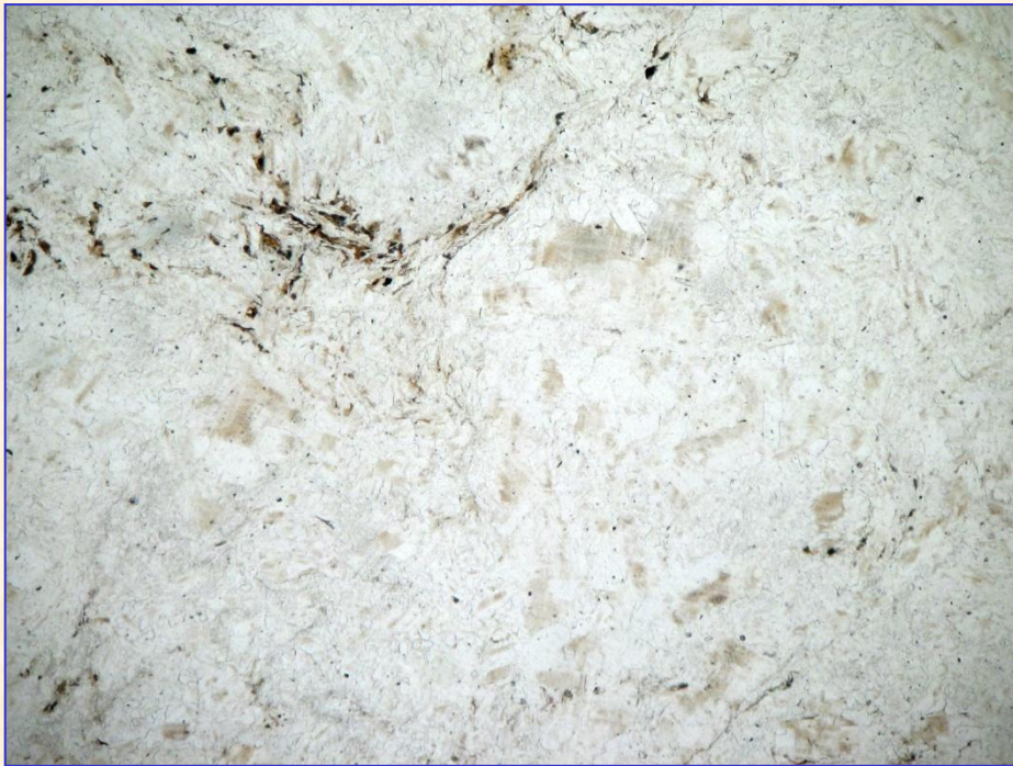
Anhydryt. Jeden polaryzator. Dłuższy bok zdjęcia-ok. 6,0 mm.
