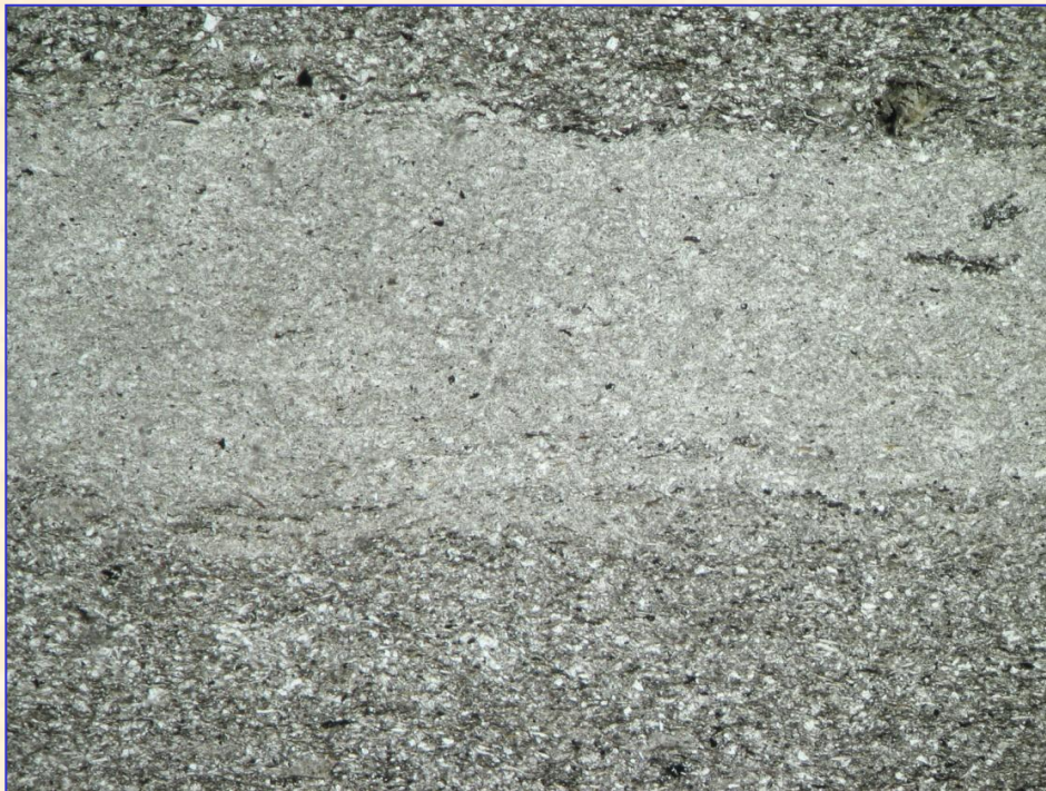
Minerały ilaste w iłowcu. Jeden polaryzator. Dłuższy bok zdjęcia-ok. 6,0 mm.
