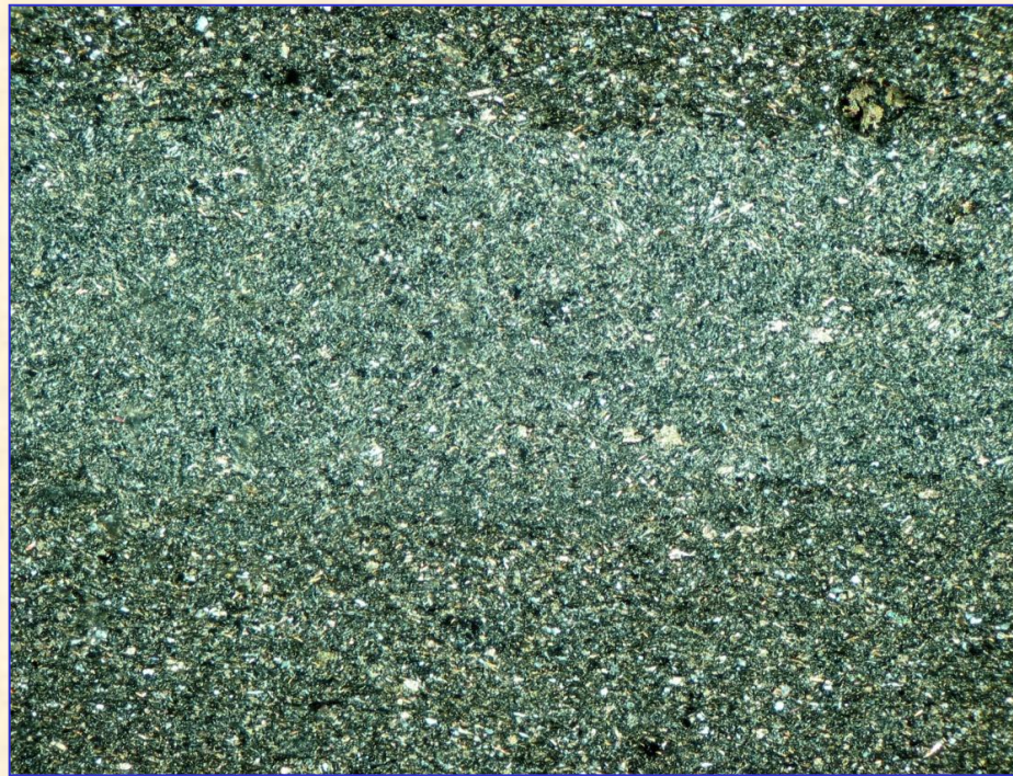
Minerały ilaste w iłowcu. Dwa polaryzatory, skrzyżowane. Dłuższy bok zdjęcia-ok. 6,0 mm.
